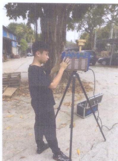
图-2 厂界无组织废气采样
